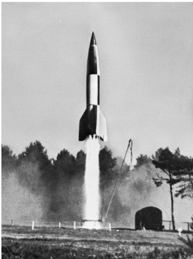
аналоговой вычислитель перед запуском. Установленные на ракете гироскопы контролировали ее пространственное положение в течение всего полета, и любое отклонение от заданной траектории выправлялось рулями на боковых стабилизаторах.
