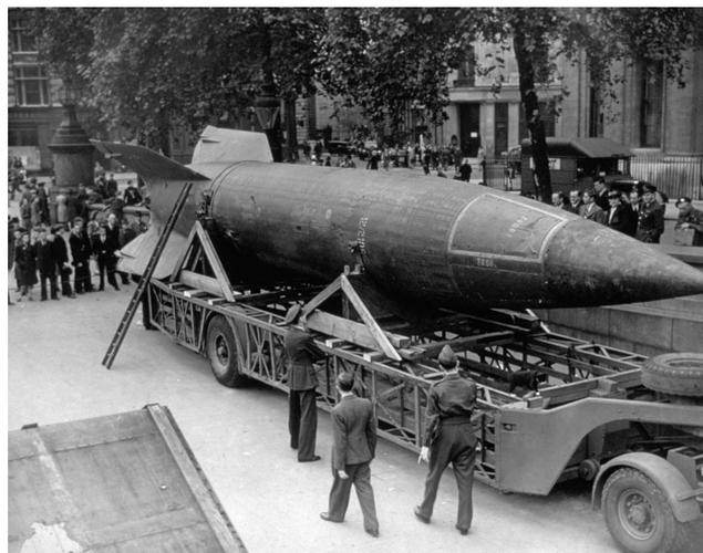
жидком топливе. Запускалась вертикально, на активном участке траектории в действие вступала автономная гироскопическая система управления, оснащённая программным механизмом и приборами для измерения скорости. Максимальная скорость полёта – до 6120 км/ч, дальность полёта достигала 320 км, высота траектории – 100 км. Боевая часть вмещала до 800 кг аммотола. Средняя стоимость – 119600 рейхсмарок.
